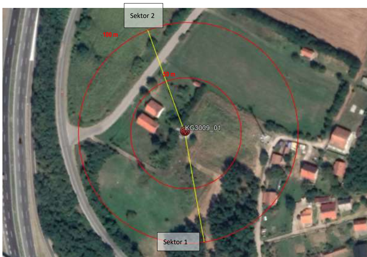
Slika 2.5 Pravci zračenja antenskih sistema predmetne bazne stanice
