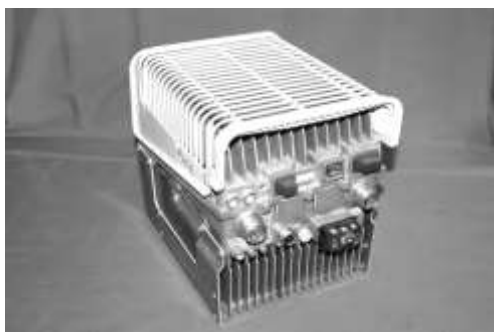
Slika 3.5 Izgled jednosektorskih Nokia Flexi radio modula
